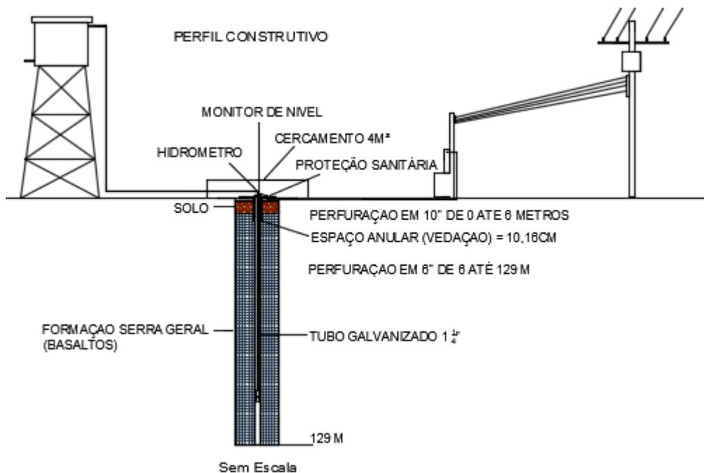
Figura 13: Perfil Construtivo do Poço. Fonte: Autor (2021).
