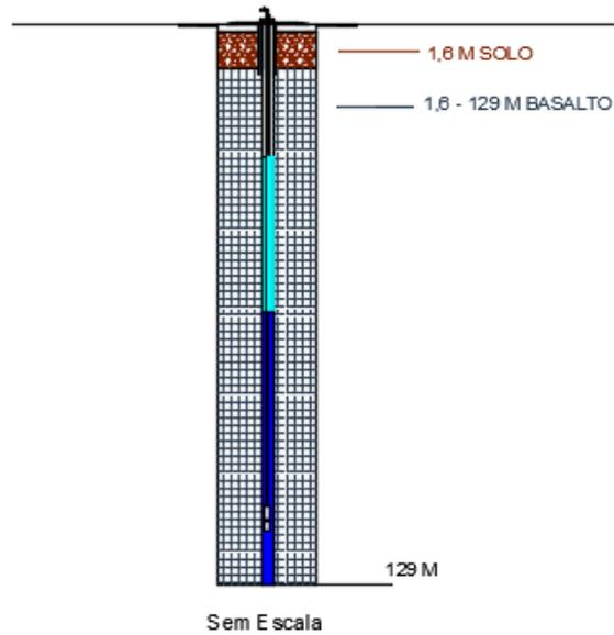
Figura 12: Perfil Geológico do Poço. Fonte: Autor (2021).
