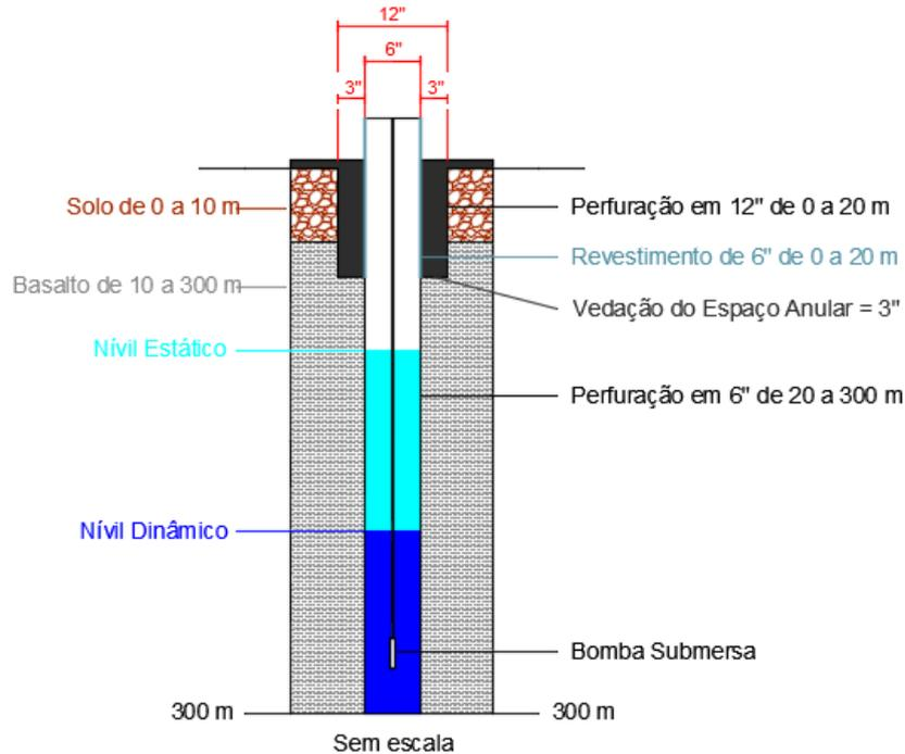
Figura 12: Perfil Geológico e Construtivo do Poço. Fonte: Autor (2025).
